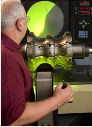
Ingersoll Rand गुणवत्ता आश्वासन हमारे Sutorbilt Legend रोटरों के विनिर्माण के लिए उपयोग किए जाने वाले औजारों के परीक्षण के लिए नवीनतम प्रौद्योगिकी का उपयोग करता है।
