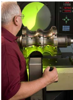
Při kontrole kvality ve společnosti Ingersoll Rand se při testování nástrojů používaných při výrobě rotorů Sutorbilt Legend používá nejnovější technologie.
