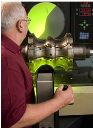
Ingersoll Rand 品質保證使用最新技術，測試生產 Sutorbilt Legend 轉子所用的工具。
